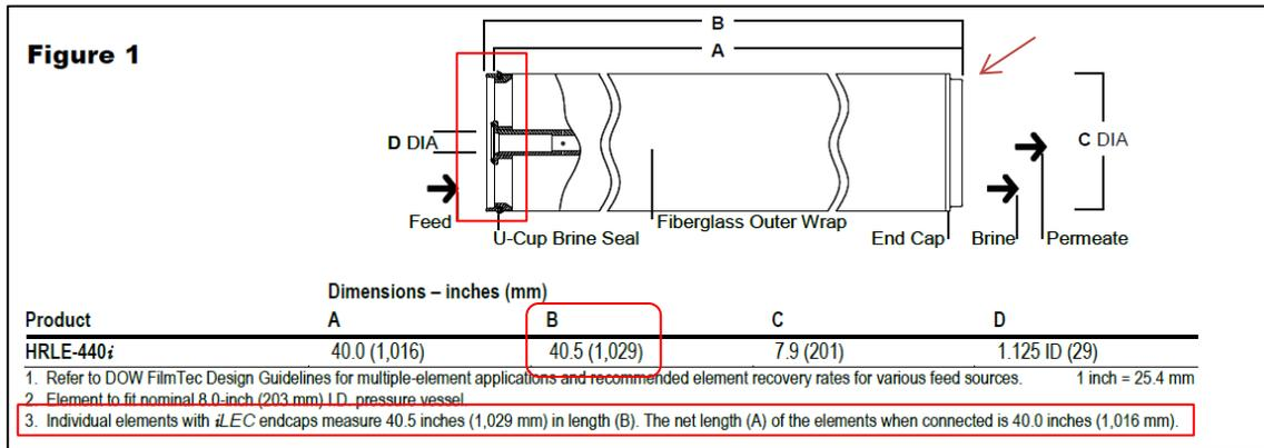
Si bien en el punto 3 de la anterior figura indica que una vez interconectados los elementos, cada membrana entra dentro de la siguiente las 0,5" de más que tienen estas membranas, la última membrana si mantendrá la longitud total de 40,5".
