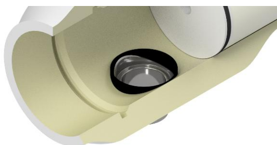
Imagen 4.10.14.1. Ensamble el puerto lateral antes de retirar el exceso de goma.
