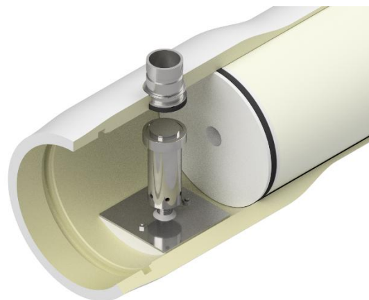
Imagen 4.9.5.2 Asegúrese de que el “Manual pusher” esté alineado con el eje del puerto.
