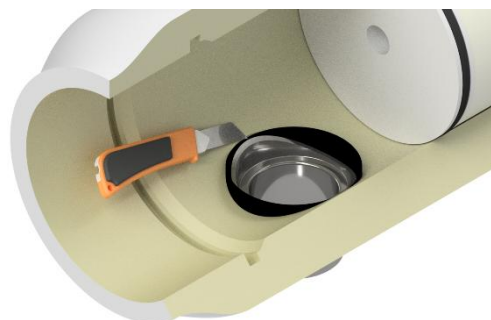
Image 4.10.16.2. Placer la lame du cutter parallèlement à la surface intérieure du récipient sous pression. Si nécessaire, utiliser le port métallique ( JAMAIS LE RÉCIPIENT ) comme support pour la lame.
