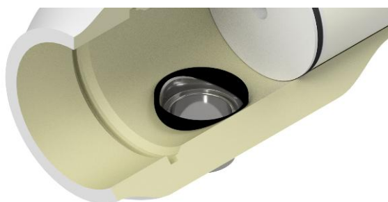
Image 4.10.14.1. Port latéral Assemblage avant de retirer l'excédent de caoutchouc.
