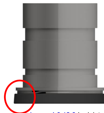
Image 4.9.12.3 Le joint est de forme trapézoïdale. Le plus grand diamètre doit se trouver en bas.
