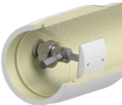
Image 4.11.13.1. La pression doit être augmentée petit à petit jusqu'à ce que le joint soit assemblé.
