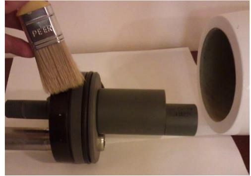
4.3.2. Colocar el empujador (pusher) (ver anexo 1) y empujar el conjunto de la tapa hacia dentro del tubo. Para evitar daños en las piezas, se recomienda no torcer la herramienta roscada en el puerto de permeado.
