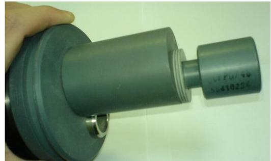
4.4.2. Usar un destornillador de punta plana para quitar el retaining ring (anillo de retención). Tal y como se muestra en las figuras.
