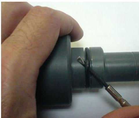
d) Junta para Adaptador para tubos de 300/450 psi (Fig. 4.4.5.1) y tubos de 600/1000/1200/1500 y 1800 psi (Fig. 4.4.5.2).
