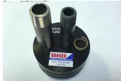
4.4.3. Desmontar el permeate port (Puerto de permeado) de la Base Plate / Sealing Plate, presionando, por el extremo roscado del permeate port, tal y como se muestra en la Fig 4.4.3.1 y Fig.4.4.3.2. Tras ello, desmontar la Sealing Plate de la Base Plate, Fig.4.4.3.3.
