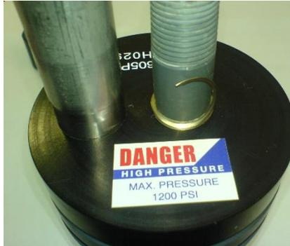
4.5.6. Aplicar una pequeña cantidad de lubricante (Molykote 111 o equivalente. También puede usarse Glicerina) en la junta del adaptador. A continuación, insertar el adaptador en el Permeate Port (con un mazo de goma).
