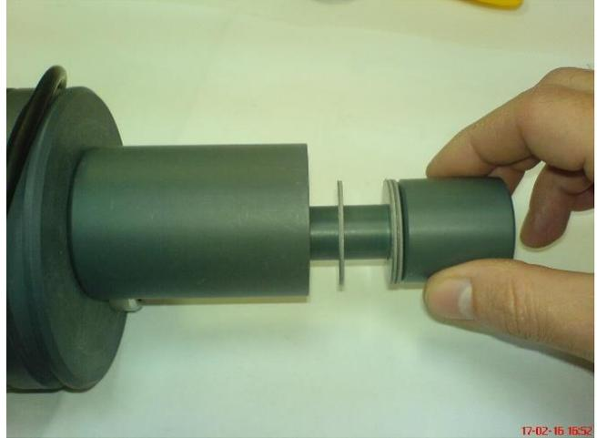
Nota: para el cierre del recipiente, aplique una pequeña cantidad de lubricante en las juntas (Junta de la tapa y juntas del adaptador) y en la ranura y el área de sellado del recipiente (consulte Sección 4.3).
